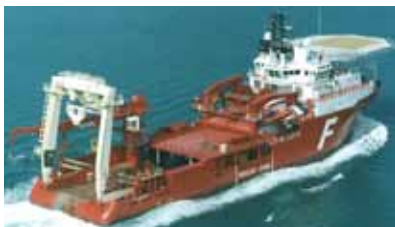
Eksempel på et offshore fartøy der dekkmaskineri drives av hydraulikk.
